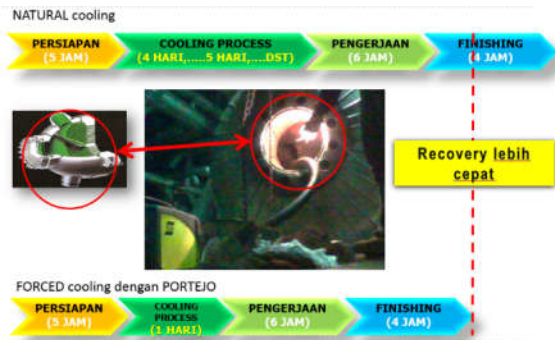
Gbr 10. Perbedaan Natural Cooling dan Forced Cooling saat perbaikan HP Heater
